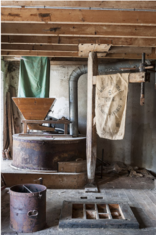
Rez-de-chaussée : une meule et sa potence.
