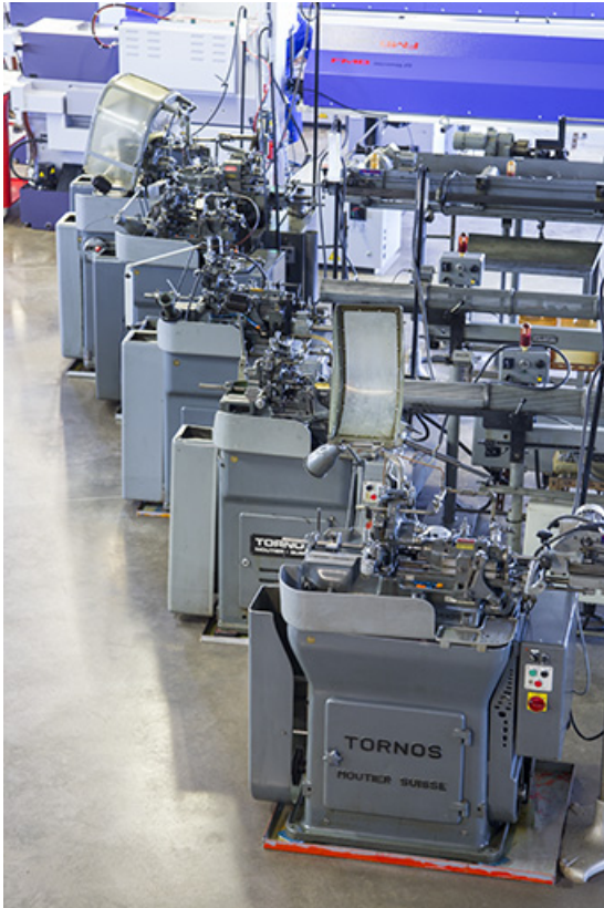
Machines à décolleter Tornos : détail des machines.
