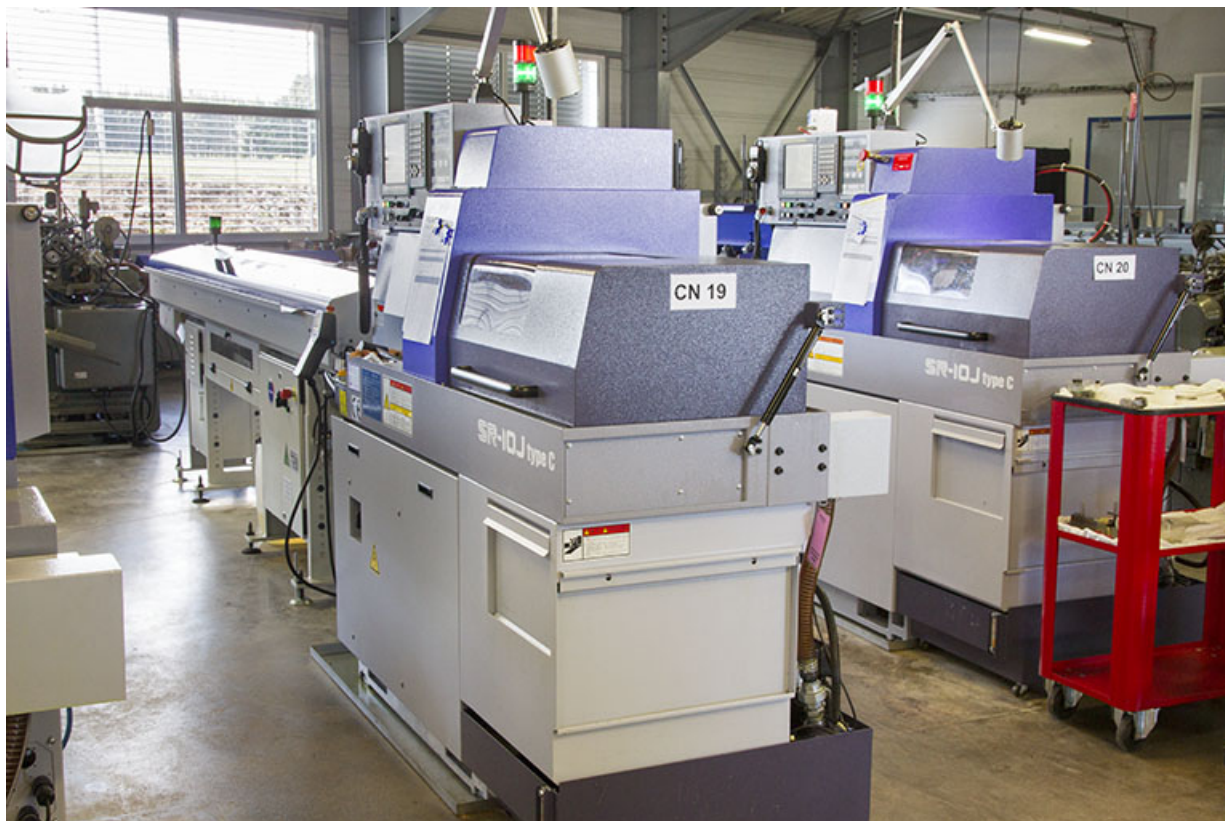
Machine à décolleter Star SR-10J type C.
