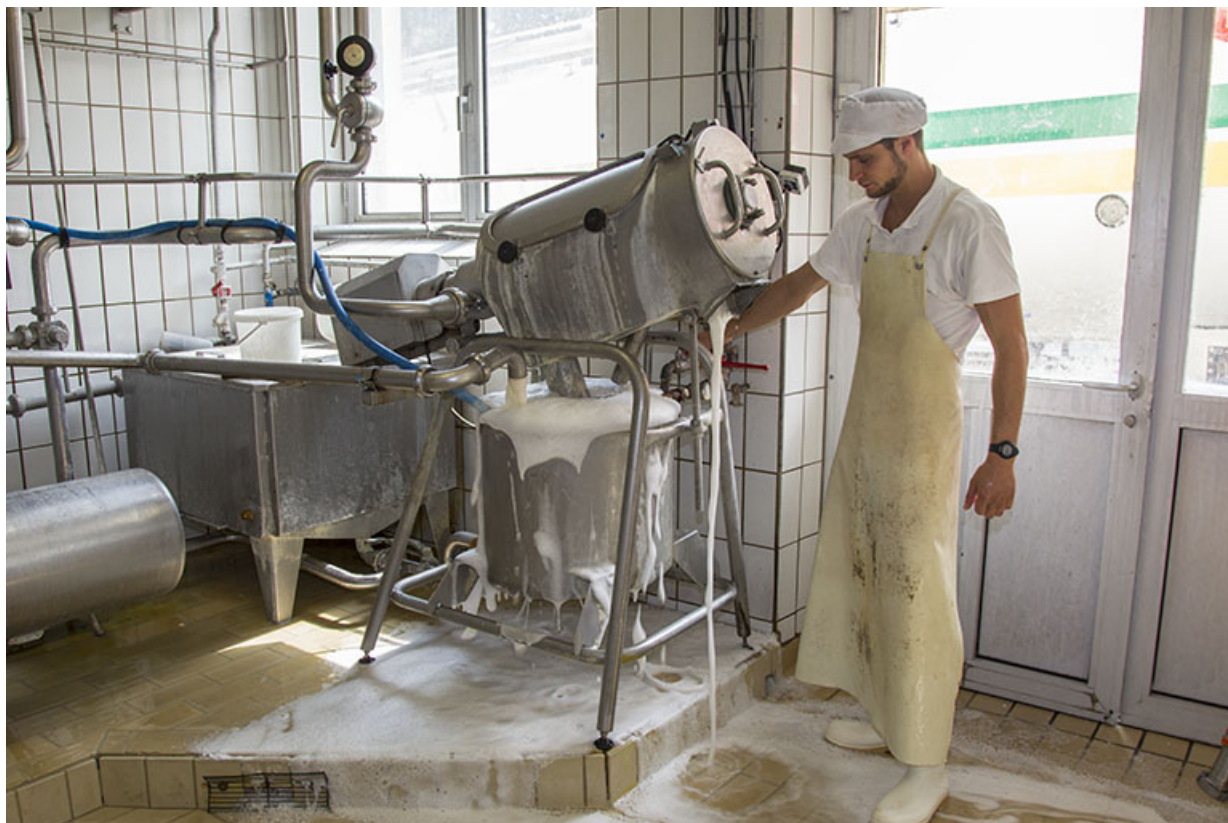
Nettoyage des installations : filtre à sérum.
