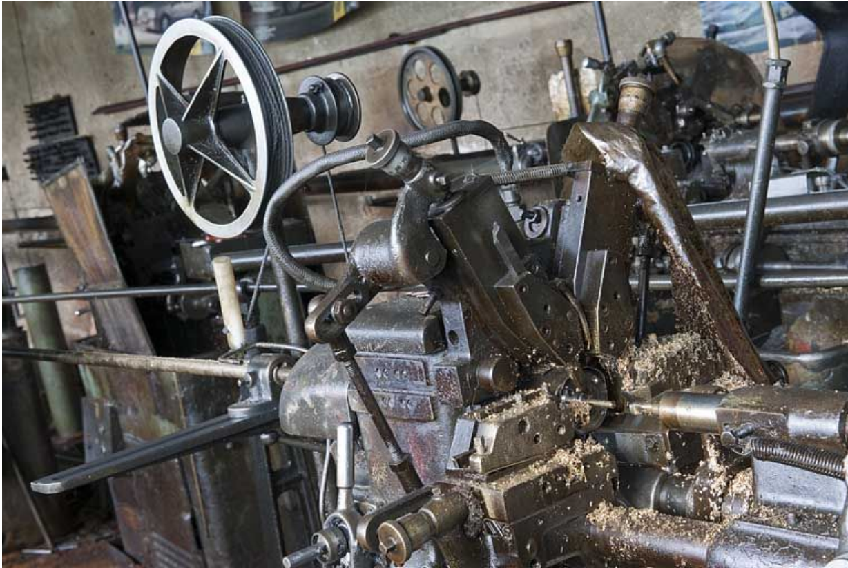
Atelier primitif. Partie supérieure d'une machine à décolleter.
