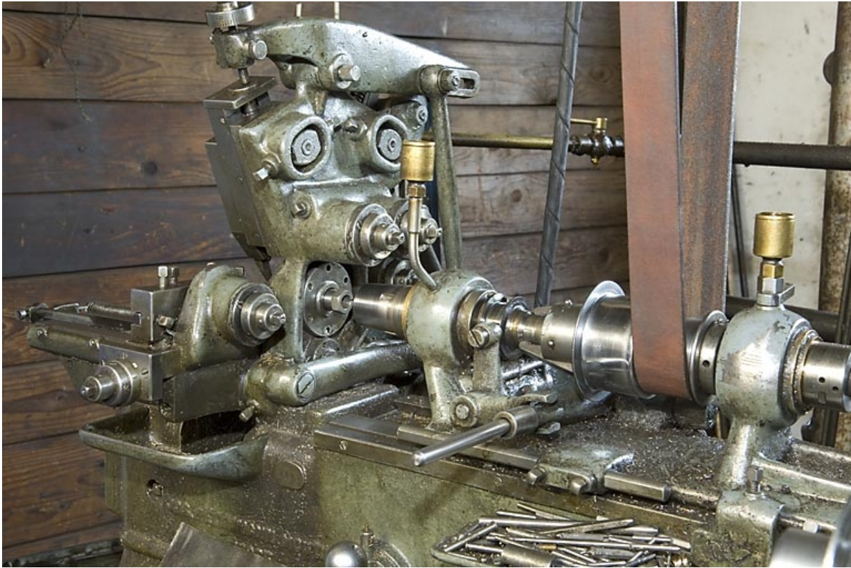
Tour à décolleter Petermann (M). Détail du système d'entraînement de la poupée mobile. 25, Besançon, 11 rue Larmet
