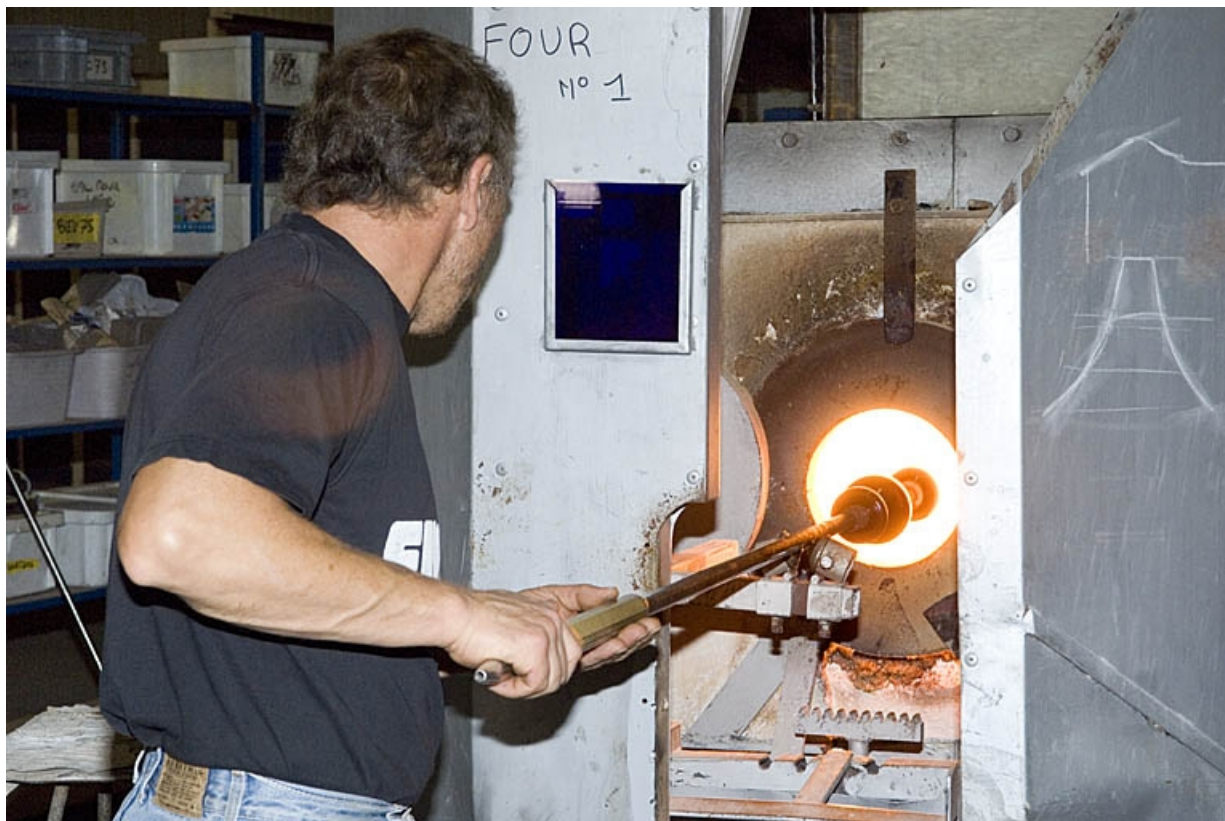
Four à réchauffer.
