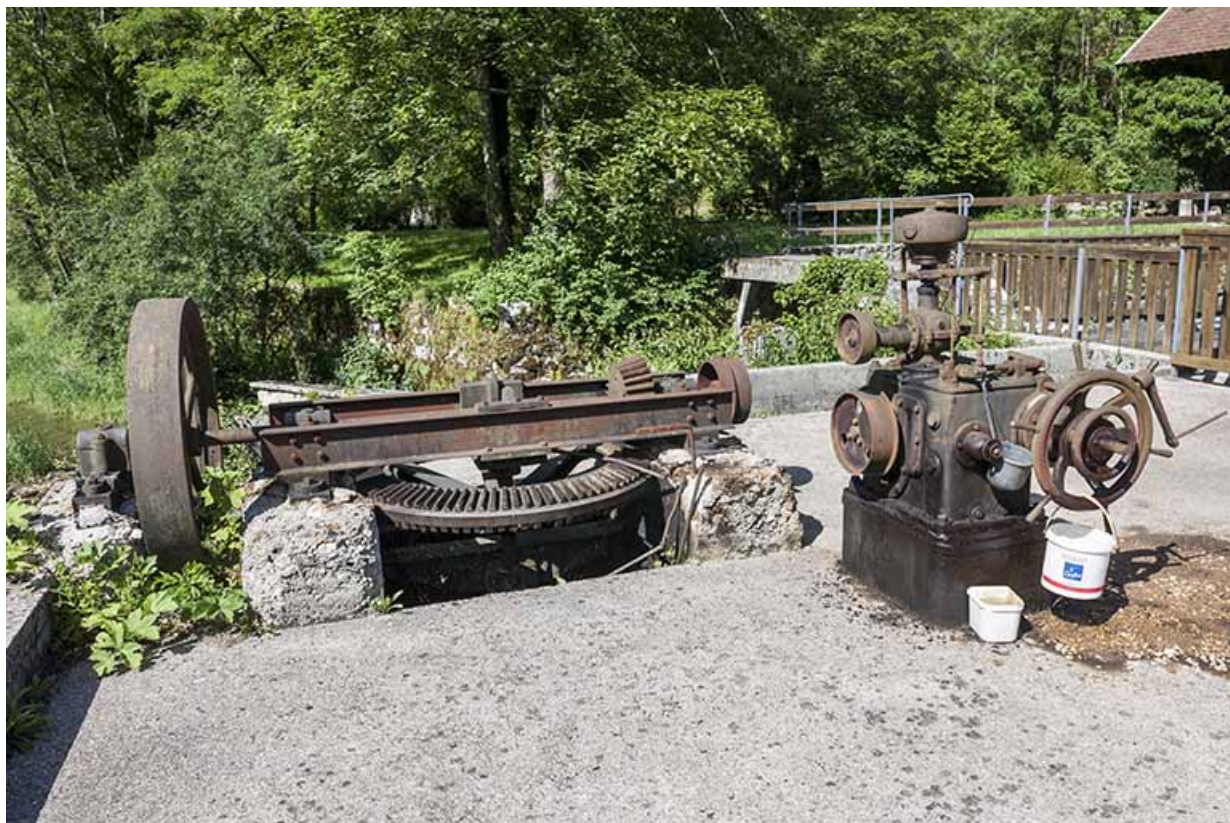
Transmission à l'aplomb de la turbine (à gauche) et régulateur Goulut-Borne.
