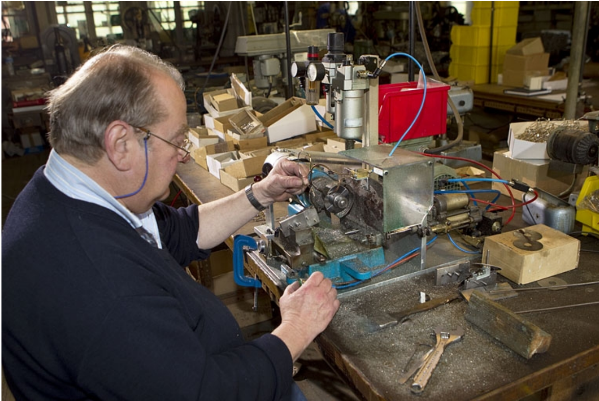
Sciage des tenons en deux (vue rapprochée).
