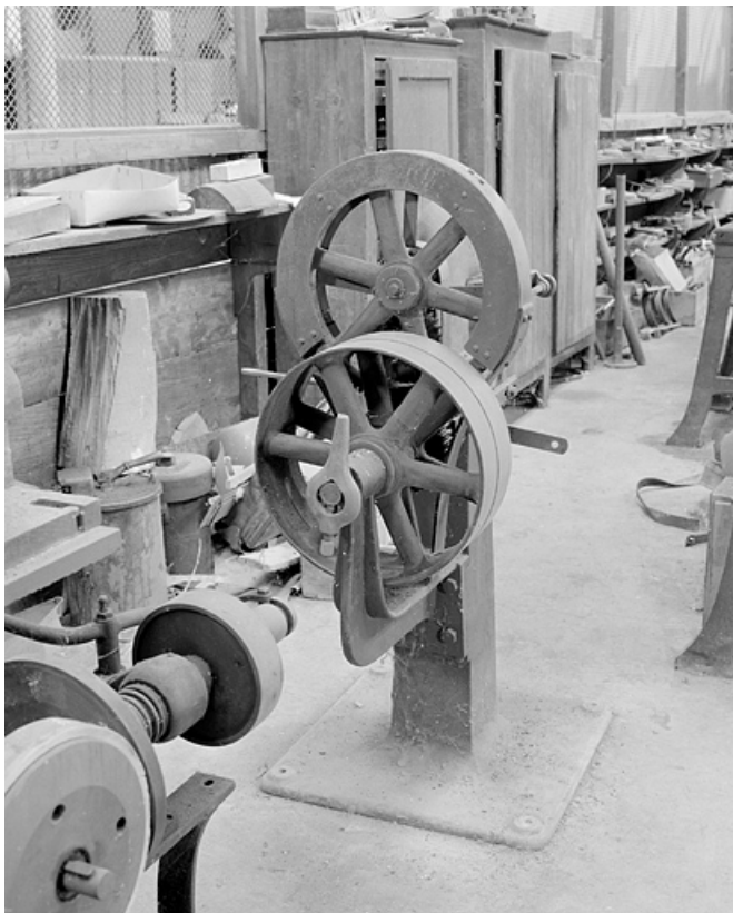
Détail des poulies de transmission.
