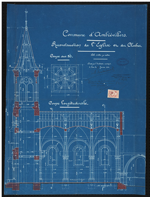
Plan présentant le projet de reconstruction du clocher et de la nef, coupe longitudinale.
