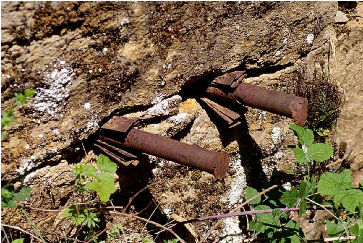
Détail de coins encore en place dans le front de taille.
