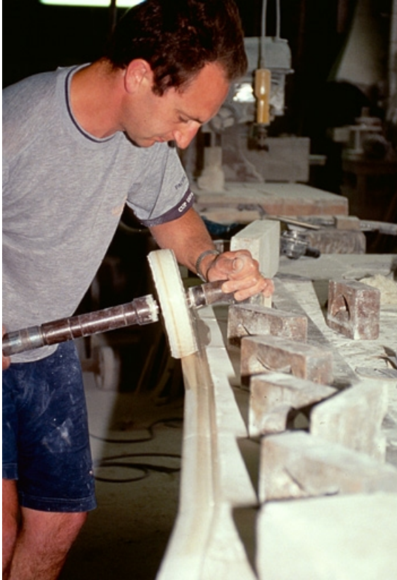
Polissage d'un limon d'escalier.
