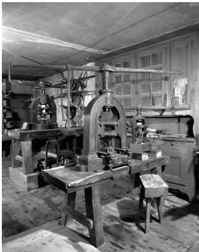
Grande presse à vis à balancier, vue de trois quarts.
