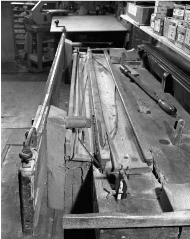
Banc à racler : système de fixation de la lame à gauche, système d'ébarbage au premier plan. 39, Longchaumois Grande Rue 26
