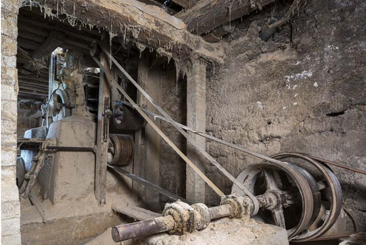
Atelier de fabrication, sciurier : transmission (poules et courroies) du châssis Socolest.
