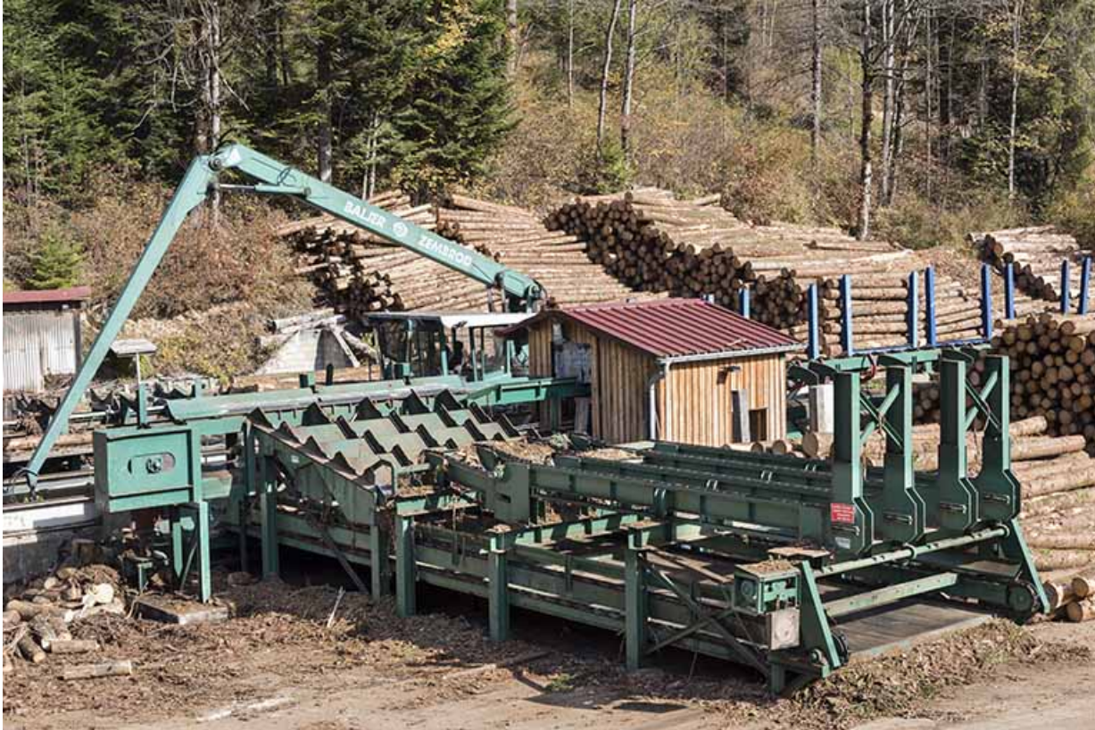
Chariot de tronçonnage Baljer Zembrod et écorceuse.
