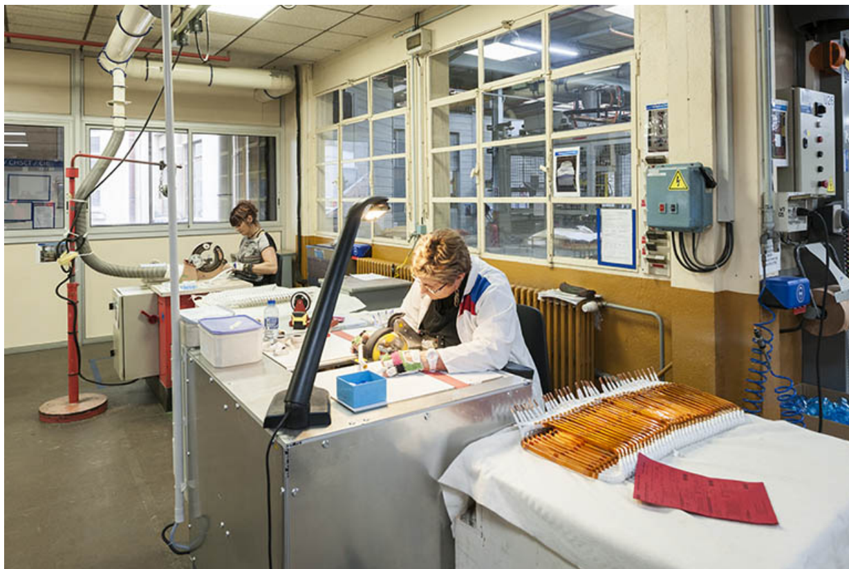
Isolation semi-automatique des barres de cuivre.
