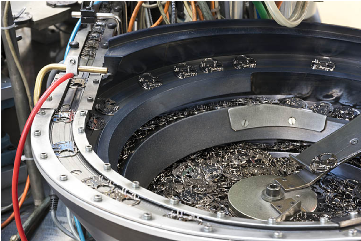
Atelier d'assemblage : détail du bol d'alimentation.
