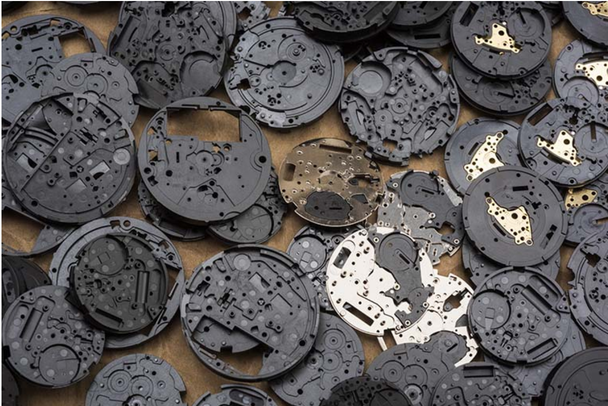
Composants fabriqués à l'usine : platines de montre.
