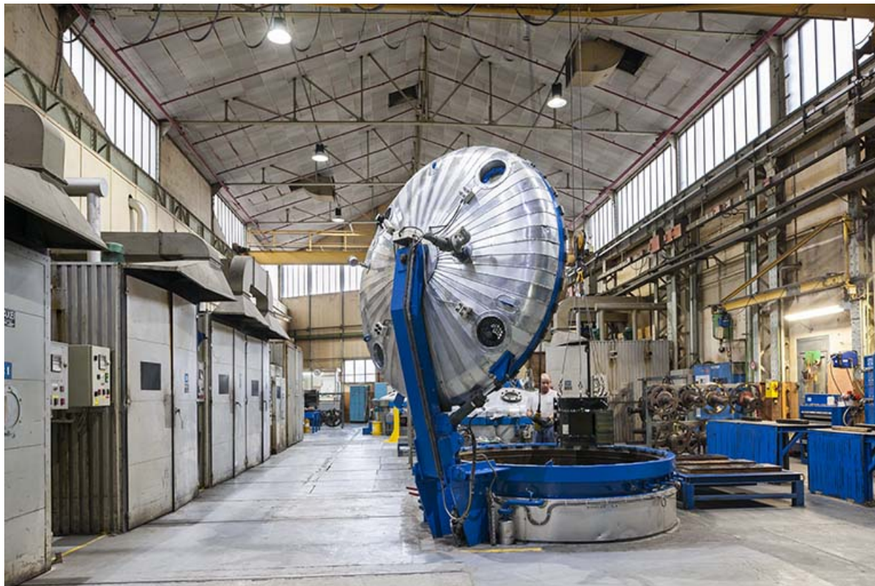
Atelier d'imprégnation (autoclave ouvert).
