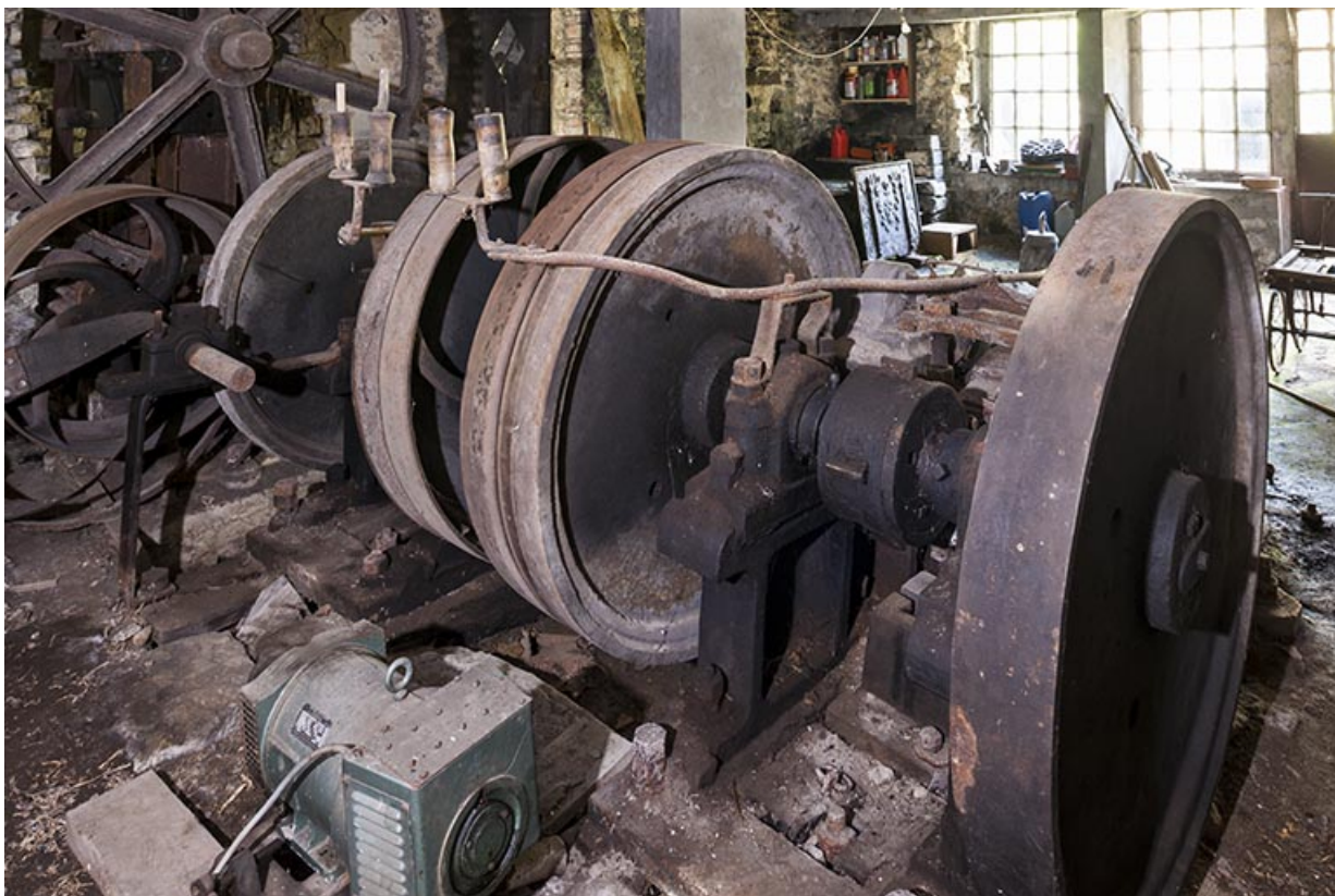
Volants du martinet et arbre à cames.
