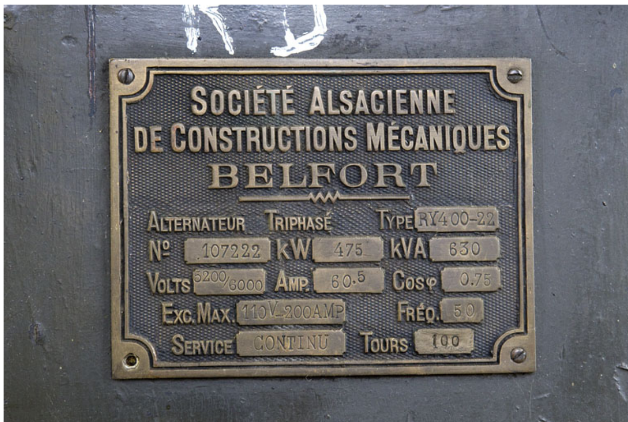
Plaque de constructeur d'un alternateur SACM.
