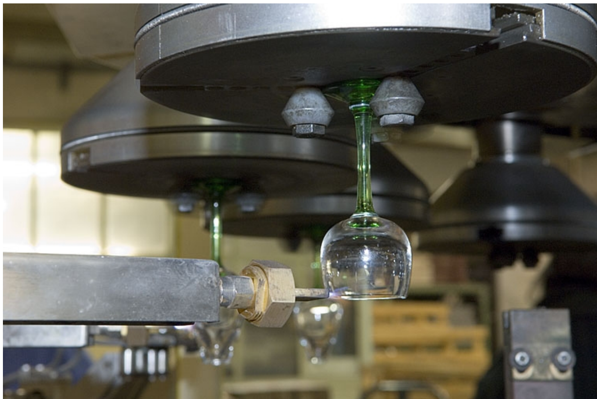
Flettage (ou rebrûlage) des bords d'un verre.
