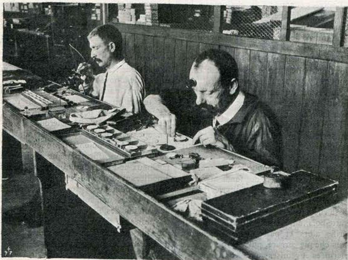
POSE DES CADRANS ET DES AIGUILLES
