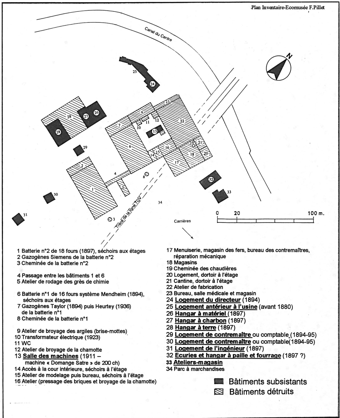
Pl. 3 : Plan masse de l'usine avant démolition en 1977, échelle 1/2000.
