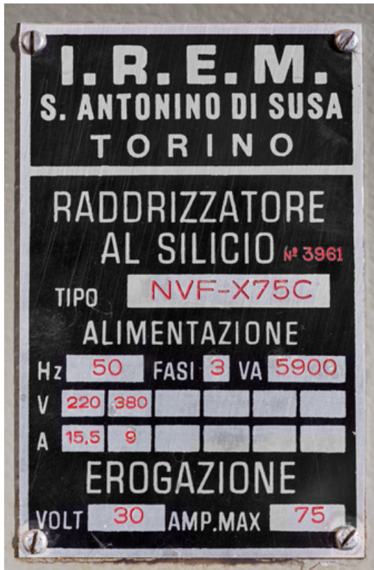
Redresseur IREM : plaque signalétique du constructeur.
