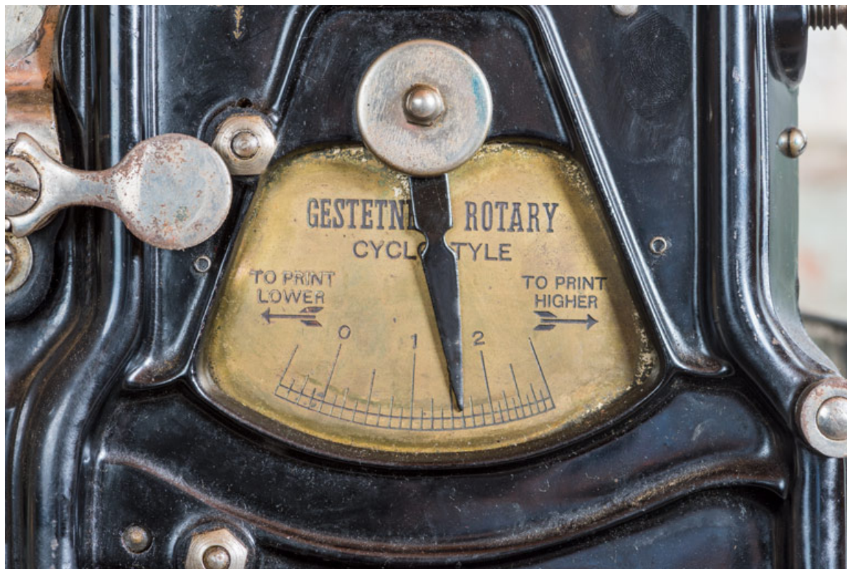
Face droite : indicateur de pression.
