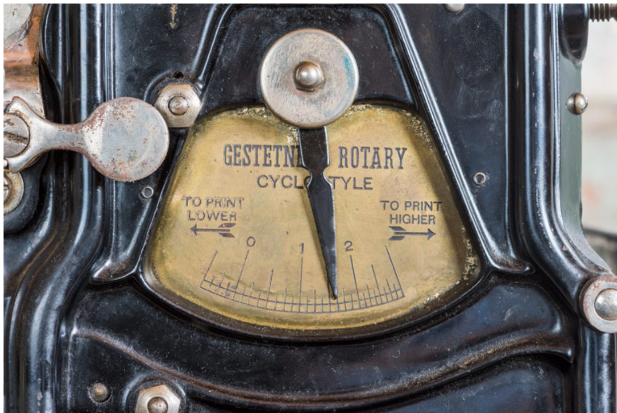
Face droite : indicateur de pression.
