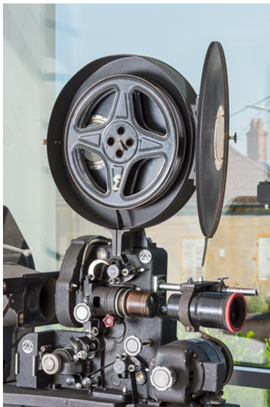
1er projecteur : porte-bobine ouvert et chrono (avec optique et moteur électrique). 71, La Clayette, 2A rue Faisant
