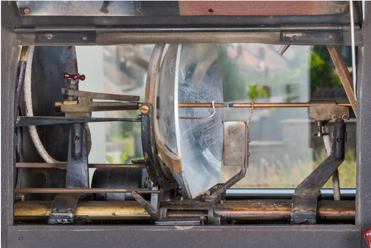
1er projecteur : lanterne ouverte, montrant miroir et électrodes.
