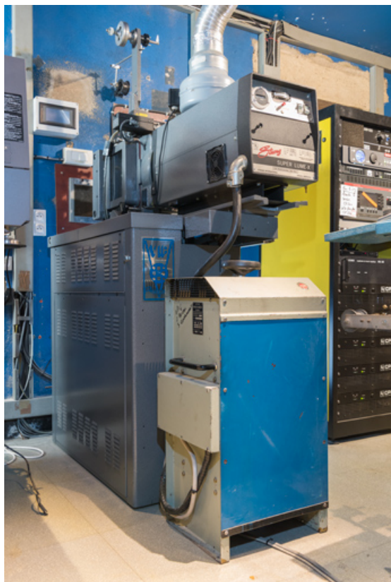
Projecteur Simplex et redresseur Prevost, de trois quarts arrière gauche. 71, Tournus, 37 rue de la République
