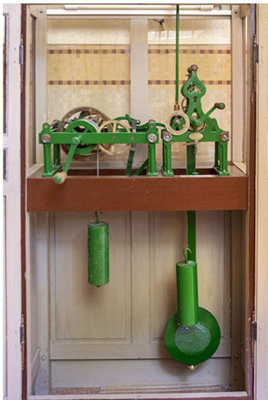
Vue du mécanisme avec ses poids et son balancier.
