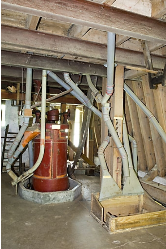
Rez-de-chaussée. Laveuse-essoreuse Teisset-Rose-Brault.
