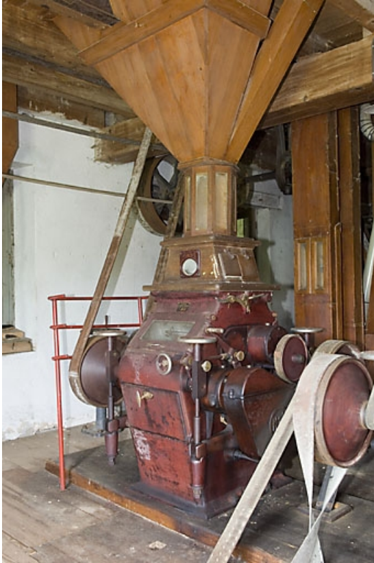
Premier étage. Appareil à cylindres doubles (convertissage). Vue de trois quarts droite.
