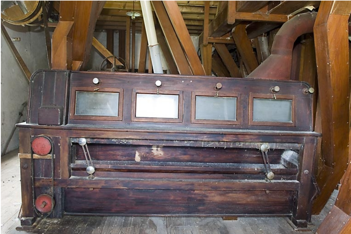
Deuxième étage. Sasseur. Vue de côté.
