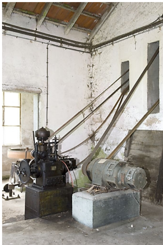
Rez-de-chaussée. Multiplicateur Goulut-Borne (de la turbine) et moteur électrique de la Cie Générale d'Electricité.
