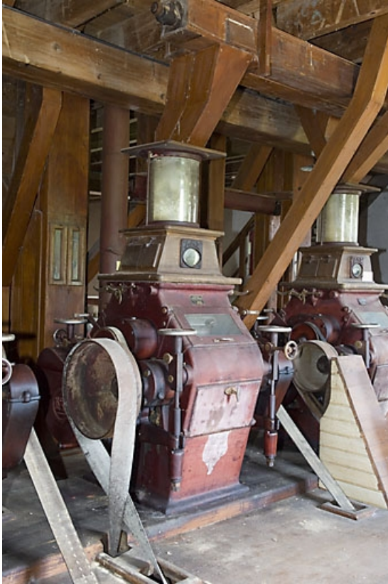
Premier étage. Appareil à cylindres doubles (convertissage). Vue de trois quarts gauche.
