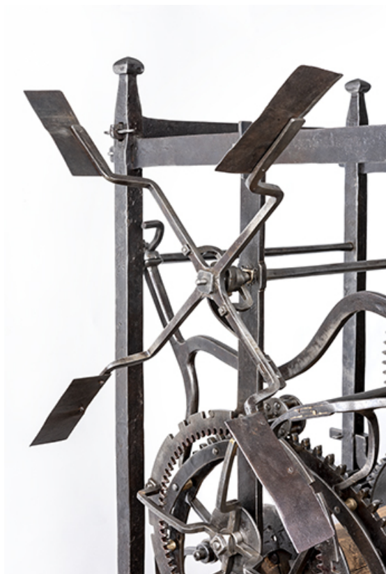
Détail de l'horloge publique : le volant régulateur de sonnerie. 39, Septmoncel
