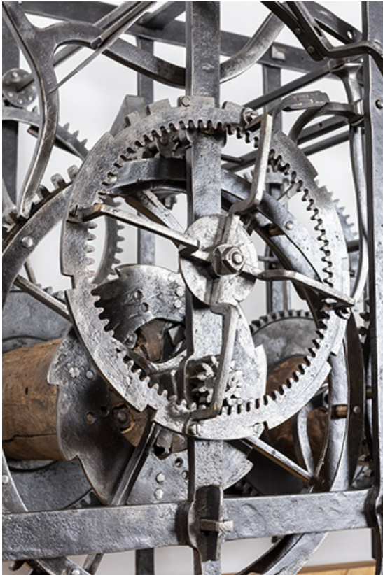
Détail de l'horloge publique : la roue de compte. 39, Septmoncel
