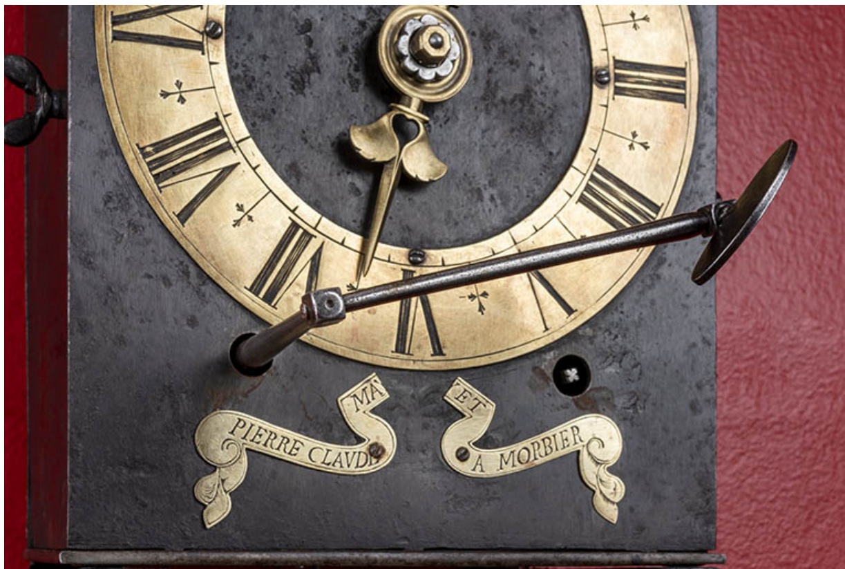
Détail du cadran, caches mobiles ouverts avec la clef insérée.
