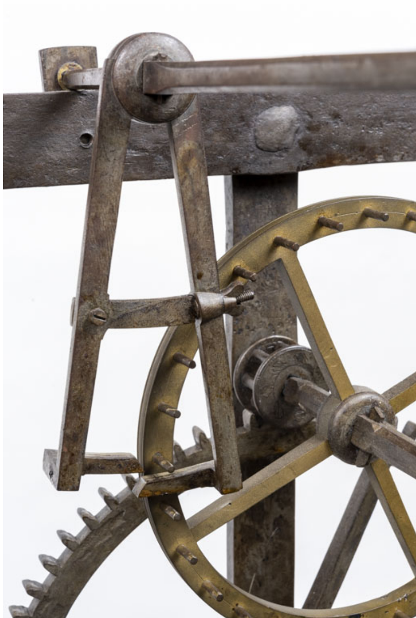
Echappement à chevilles : ancre et roue d'échappement.
