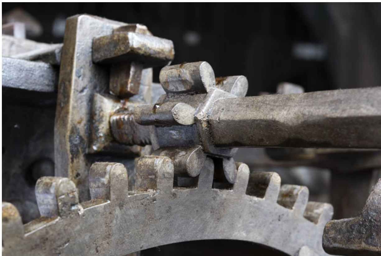
Roue dentée et pignon : détail de la denture. 39, Orgelet place de l' Eglise
