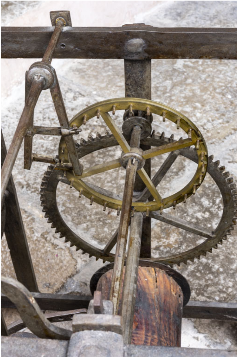
Corps avant droit (partage du temps) : échappement à chevilles, vu en plongée. La roue d'échappement (en laiton) est munie de chevilles qui interagissent avec l'ancre à gauche.
