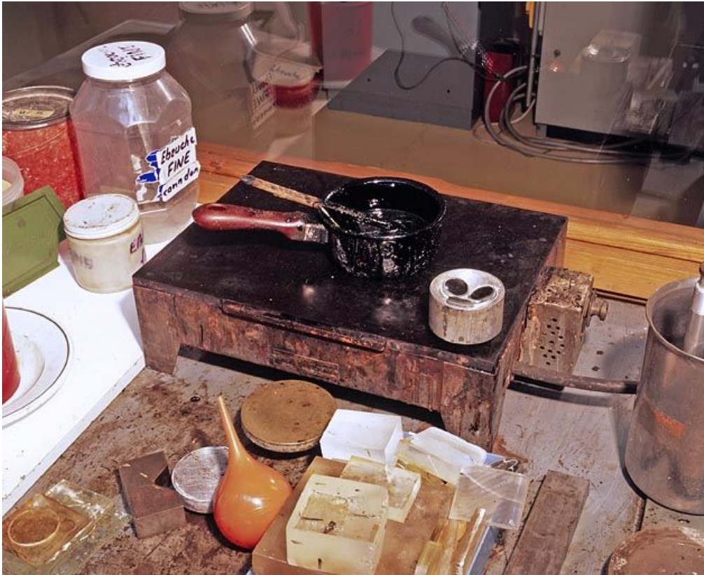
Chauferette pour le polissoir à poix. Bâtiment de l'enseignement (F), atelier de fabrication des composants optiques. Déposée à la surface de l'outil, la poix en épouse la forme et use le composant via un produit abrasif intercalé entre eux.
