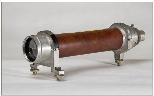
Collimateur. Il permet à un autre instrument de faire des visées à l'infini.
