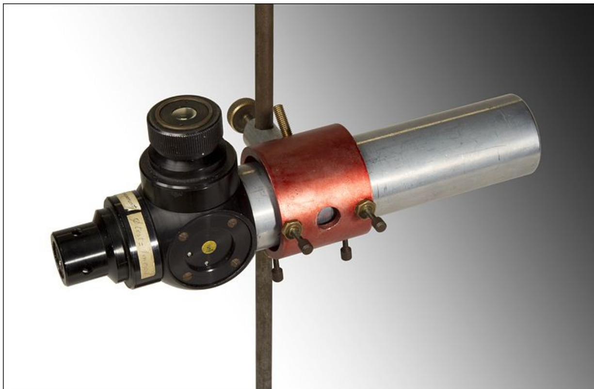
Lunette autocollimatrice. Cette lunette est utilisée pour évaluer l'orientation de plans.
