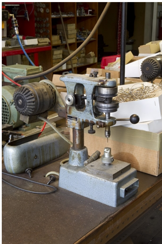
Machine n° 1187, carter de protection ôté.
