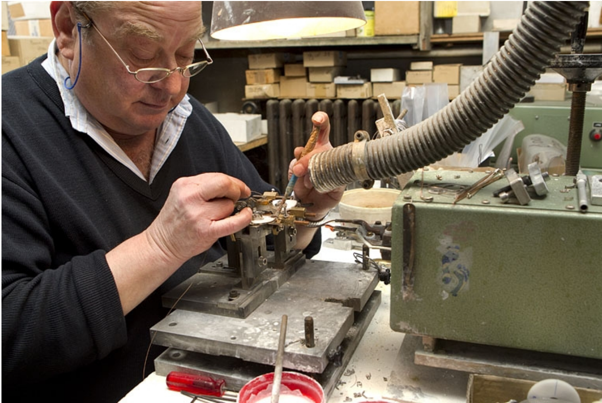
Soudage sur la machine à souder Himmel.
