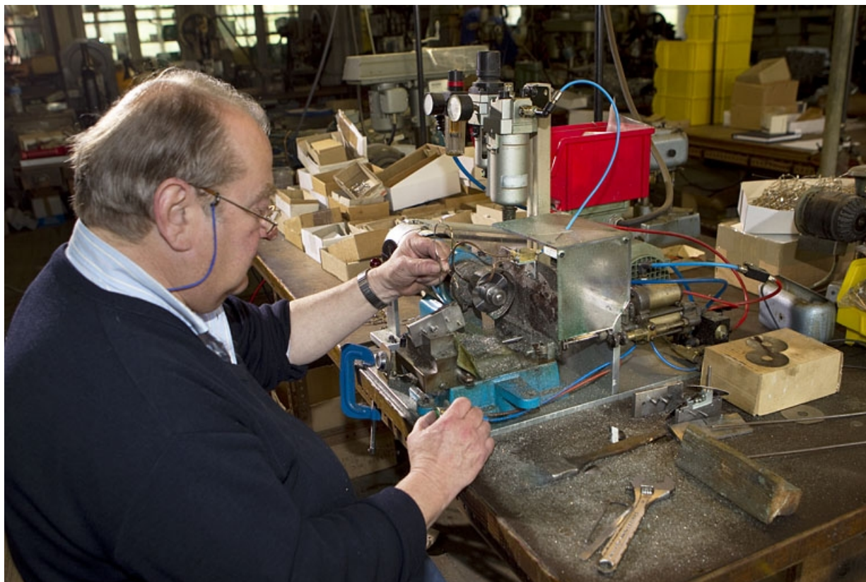
Sciage des tenons en deux (vue rapprochée). 39, Morez, 66 rue de la République
