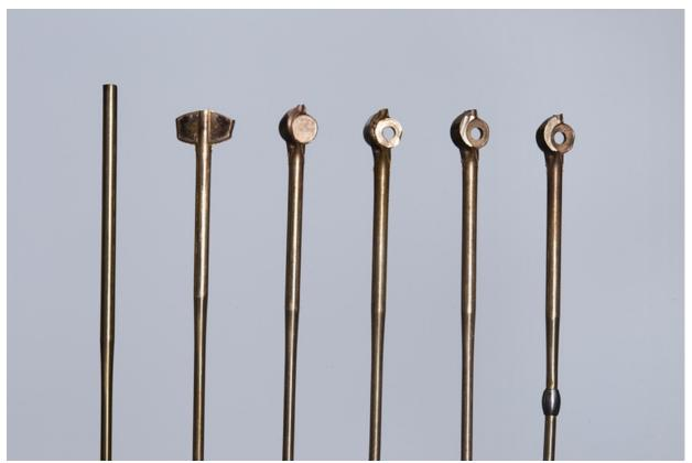
De gauche à droite, fil de bronze après refoulage et talonnage, perçage de l'oeil, mise à la largeur du chapeau, fraisage de l'oeil et du talon, sertissage de l'enjoliveur.
