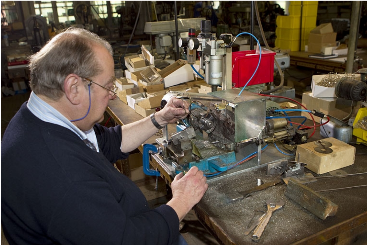
Sciage des tenons en deux (vue rapprochée).
