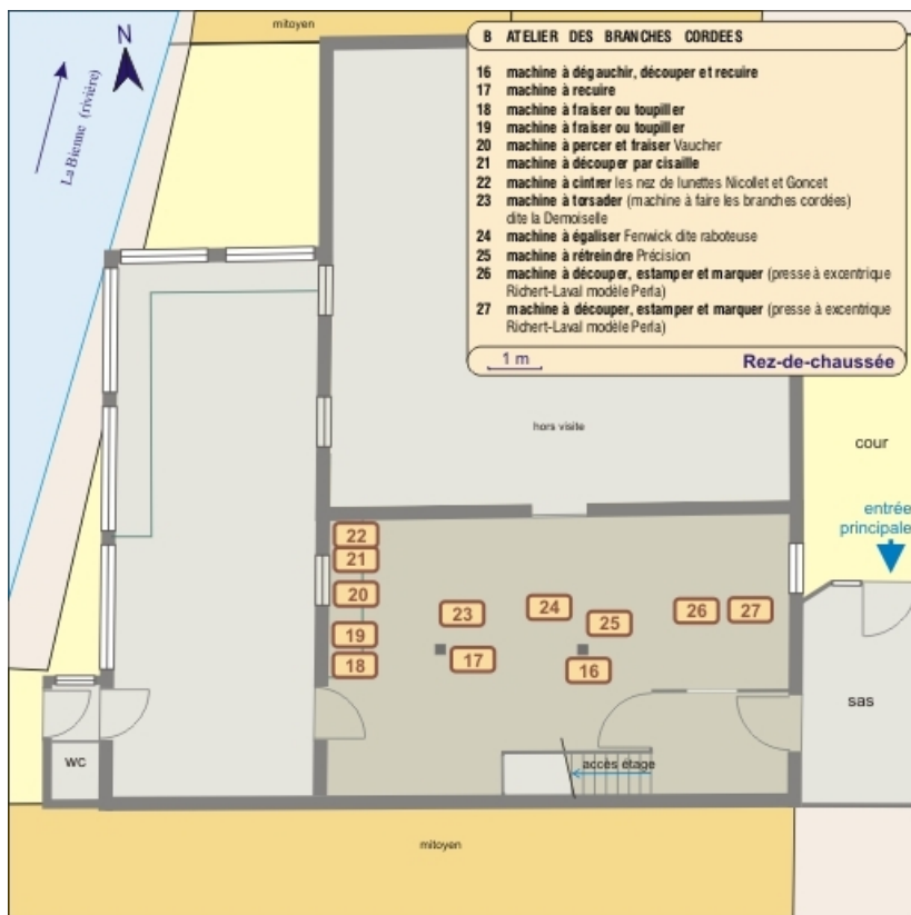
Atelier des branches cordées : schéma de distribution des machines. Echelle 1:90. 39, Morez, 66 rue de la République
