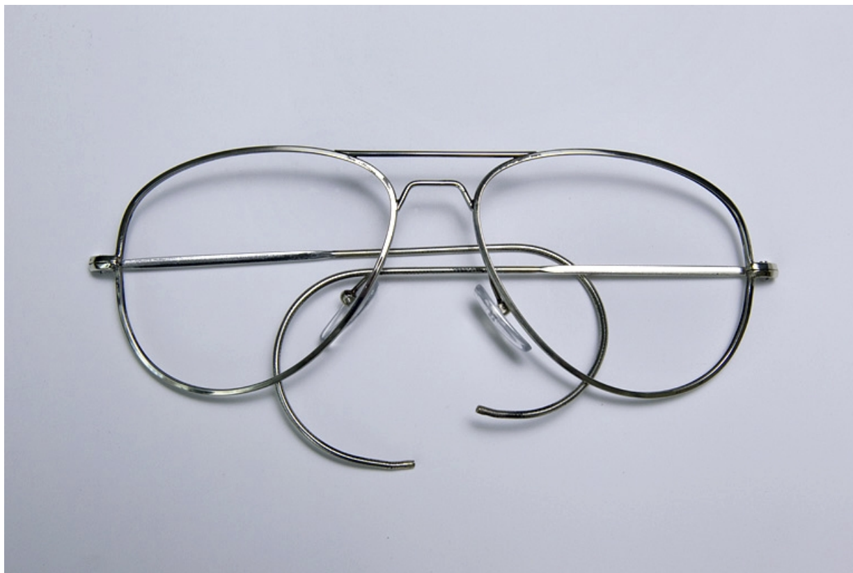
Monture de lunettes à branches cordées. La monture est en cours de fabrication : le nez et la barrette relient les deux cercles et chaque charnière est vissée sur les deux tenons, mais il manque la boule à l'extrémité des branches.
