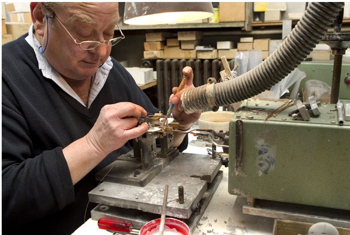
Soudage sur la machine à souder Himmel.
