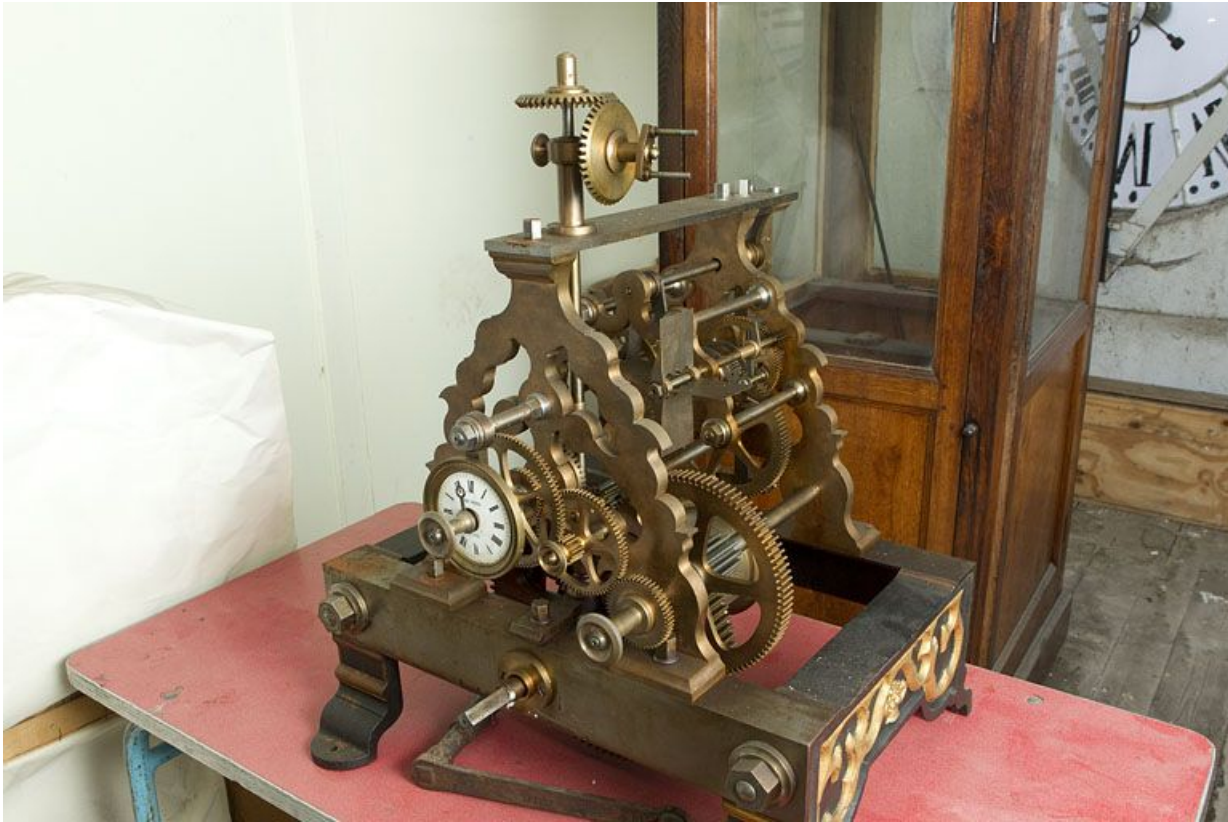
Mouvement : cadran de contrôle et roues dentées.
