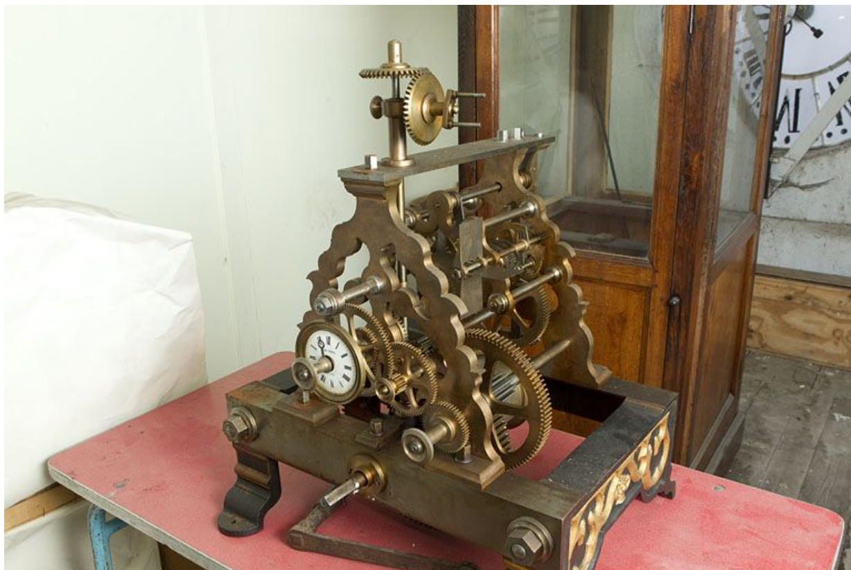
Mouvement : cadran de contrôle et roues dentées.
