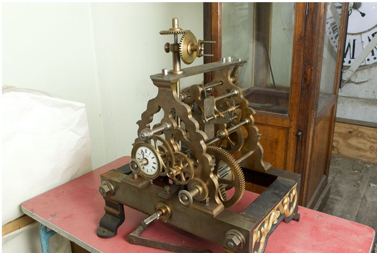
Mouvement : cadran de contrôle et roues dentées.
