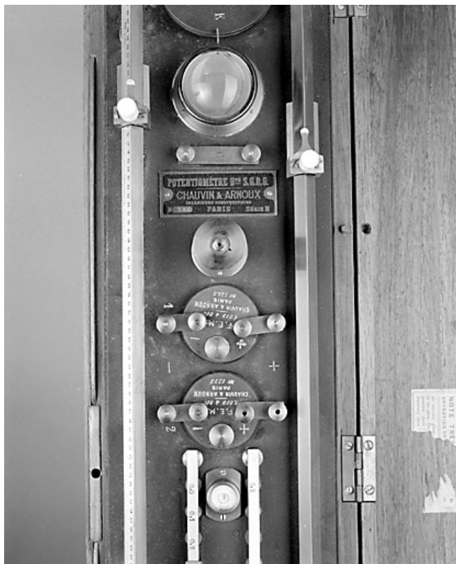
Partie gauche de l'appareil : galvanomètre, plaque du constructeur, piles et barrettes. Les deux thermomètres sont en place. 39, Morez, 35 quai Aimé Lamy
