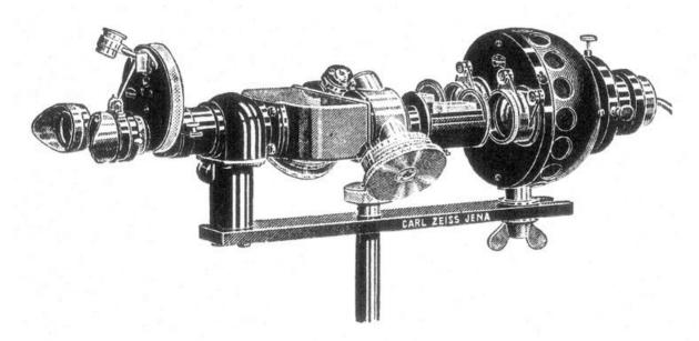
Photomètre de Pulfrich et sa lampe, montés sur rail, pour mesures d'absorption sur des liquides, 1935-1937 ? 39, Morez, 35 quai Aimé Lamy
