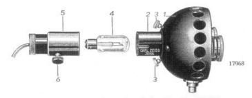
Fig. 1. La lampe d'éclairage du photomètre de Pulfrich.
