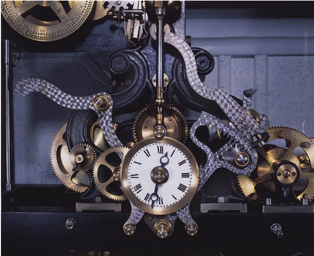
Mouvement : cadran de contrôle et râteau de la sonnerie.
