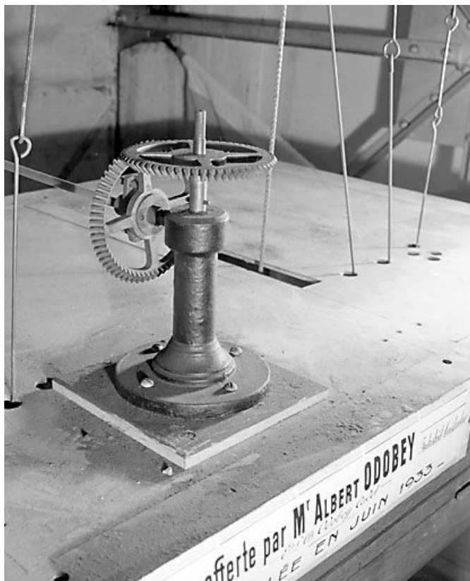
Système d'entraînement des aiguilles du cadran extérieur : renvoi d'angle. 39, Morez, 35 quai Aimé Lamy
