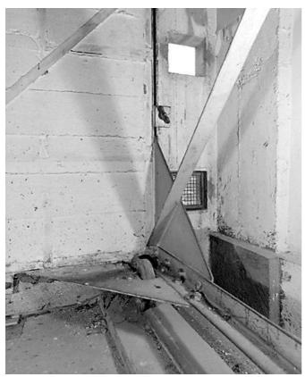
Roue et chemin de roulement du chariot mobile portant le cadran extérieur. 39, Morez, 35 quai Aimé Lamy
