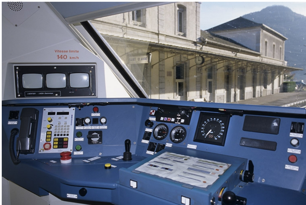
Intérieur : poste de conduite (extrémité côté La Cluse), de trois quarts. 39, Saint-Claude place de la Gare
