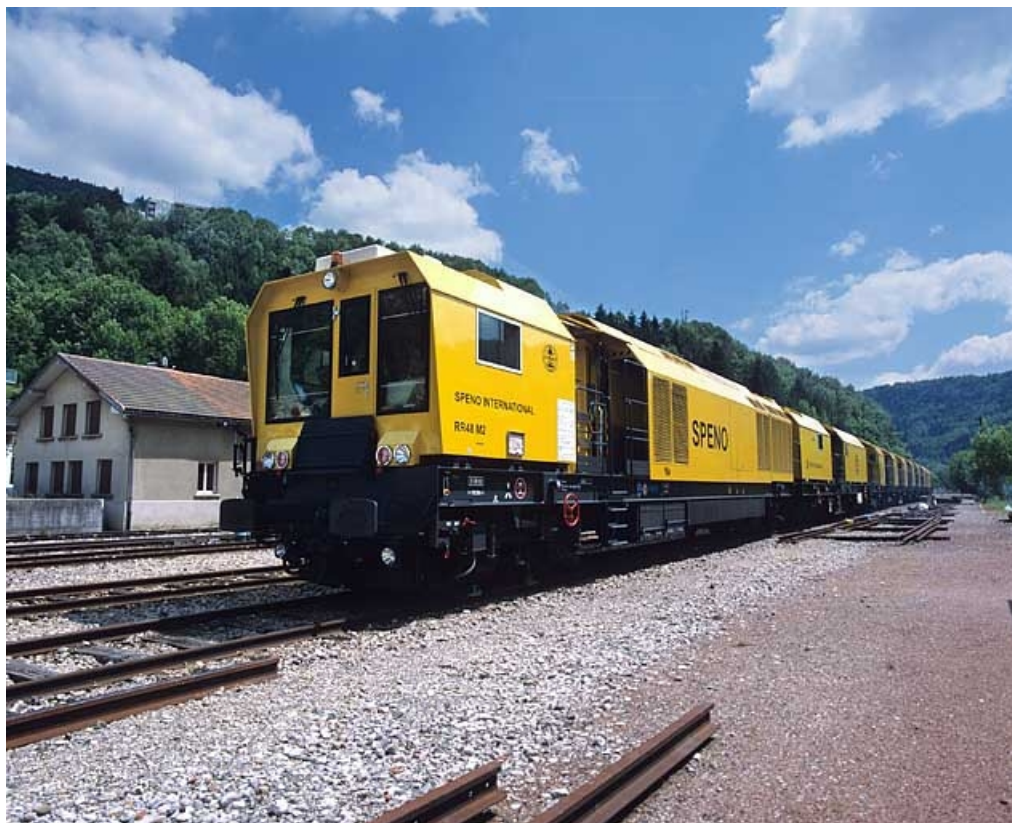
Train de meulage : vue d'ensemble en gare de Morez (trois quarts avant). in, Jura
