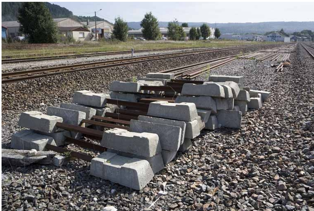
Vue d'ensemble de traverses Stradal, en gare de Champagnole. in, Jura
