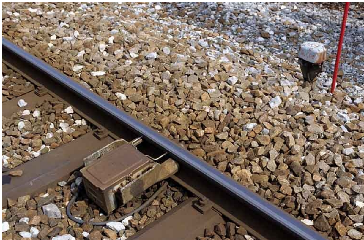
Pédale électromécanique Forflex : vue d'ensemble. Associée à un " crocodile ", cette pédale commande l'annulation de sa mise en charge lorsqu'il est pris à revers.
