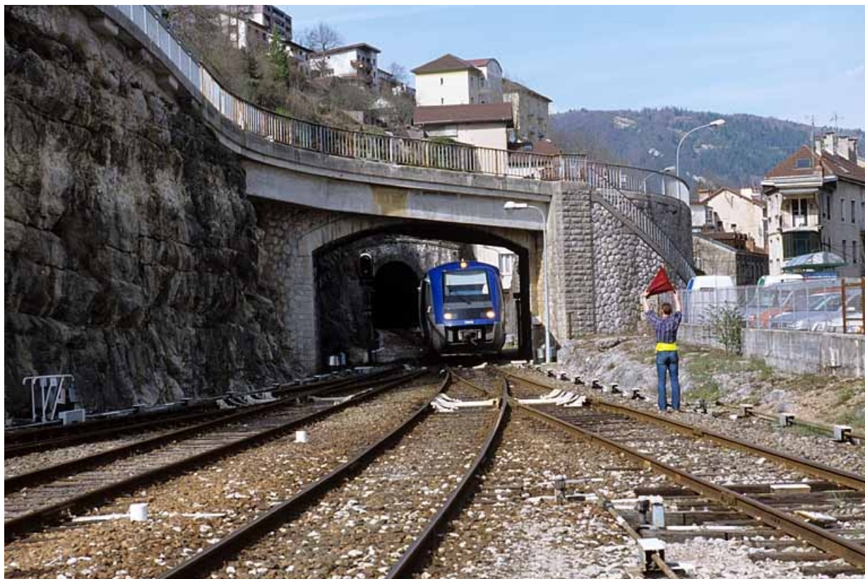
Garage d'un autorail X 73500 sur la voie 11 : l'agent donne le signal d'arrêt avec son drapeau rouge. 39, Saint-Claude place de la Gare
