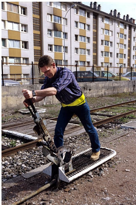
Garage d'un autorail X 73500 sur la voie 11 : manoeuvre de l'appareil de voie C par un agent. 39, Saint-Claude place de la Gare
