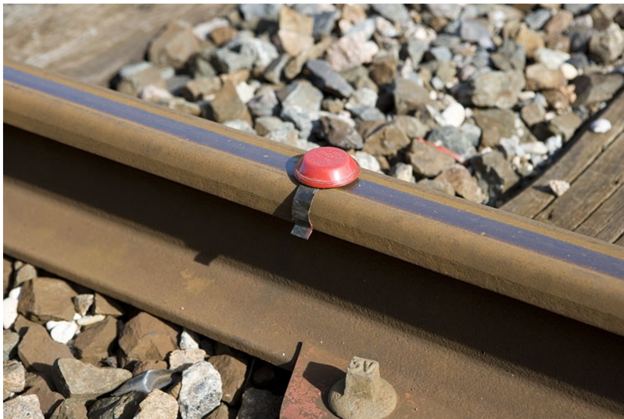
Vue d'ensemble d'un pétard fixé sur un rail.
