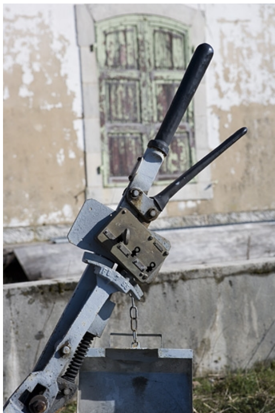
Levier de manoeuvre : détail de la serrure et de sa clef.
