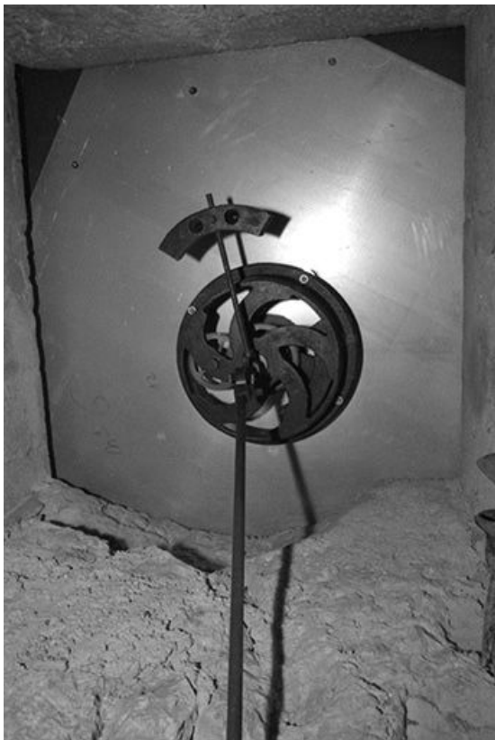
Mécanisme des aiguilles du cadran extérieur sud.
